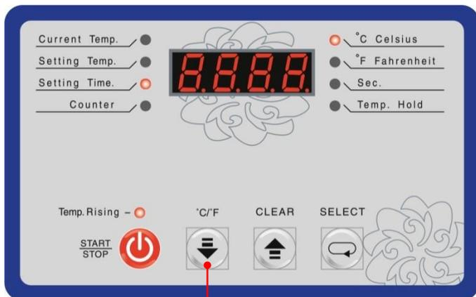
5. Нажмите кнопку «START/STOP» для включения нагрева термопресса до установленной температуры (начнет мигать индикатор Temp.Rising).
