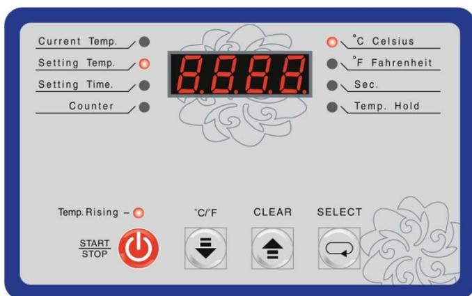
3. При включении, на экране отобразится (в течение 3 секунд) установленная температура, нажмите кнопку "SELECT" для изменения установленных параметров (при помощи этой кнопки мы попадаем в меню всех настроек термопресса, поочередным ее нажатием, во время перемещения загорается соответствующий индикатор)
